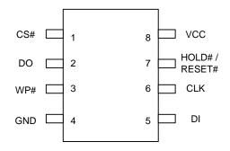
Figure 3.1 SOP8 (150/208mil)/ DIP8 (300mil)
