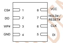
Figure 3.2 DFN8 (5\*6 mm)
